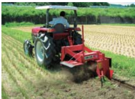
明渠機による排水改善試験（平成14年）
