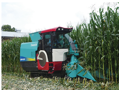
写真1 イアコーンを収穫する汎用型飼料収穫機
