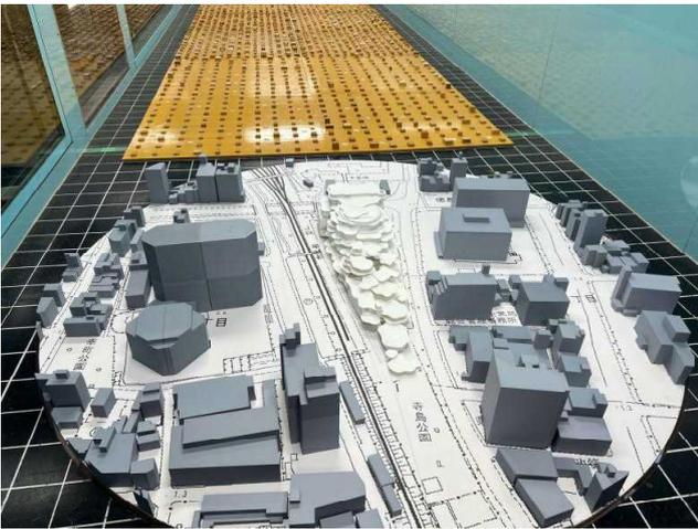
縮尺1/250の試作模型による風洞実験
