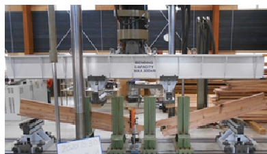
図2 実大曲げ強度試験の状況
