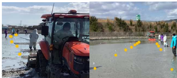
写真3 非熟練者の代かき作業(左:直進アシストなし、右アシストあり)
