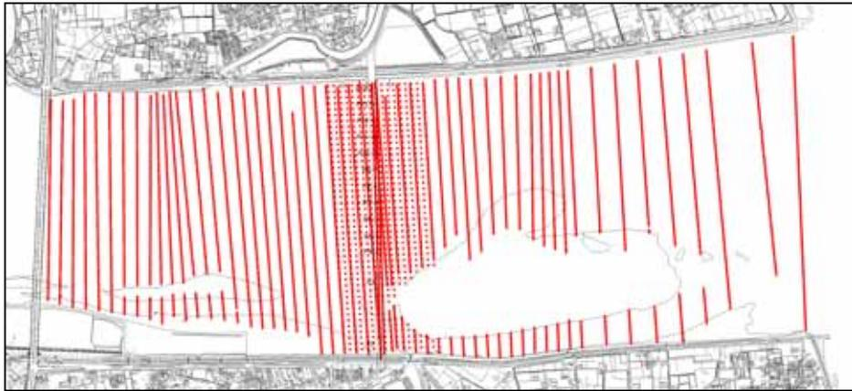
图 3 - 5 深浅测量实施箇所 (H16.10.6 ~ 10.15)
