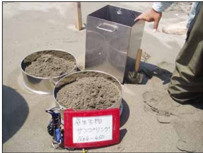
25×25×50cm の柱状サンプリング用コドラート
