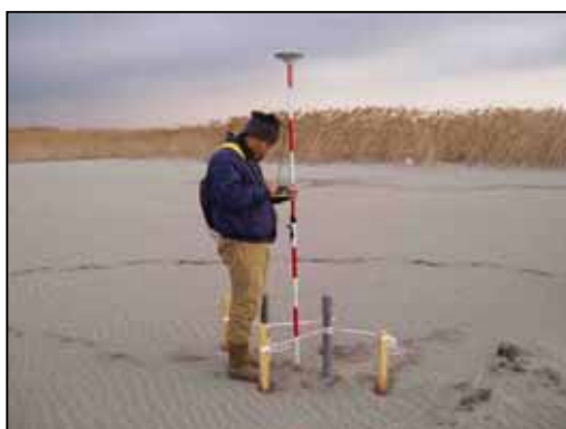
VRS 計測状況
