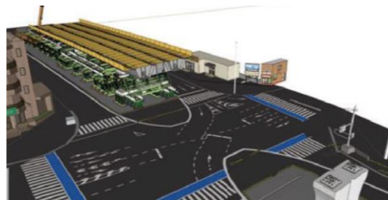
⑤安宅交差点 (多軸式特殊台車による一括架設)
