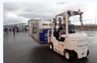
とくしまあな波おどり空港で稼働する 燃料電池フォークリフト
