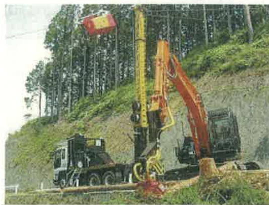
高性能林業機械（タワーヤードとハーベスタ）
