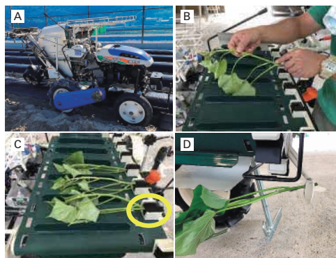
図1 Aは挿苗機、Bは苗供給ベルトに苗をセットする様子、Cは苗がセットされた苗供給ベルト、Dは植付爪に苗が把持された様子（写真中の○はブラシ式苗挟持部）
