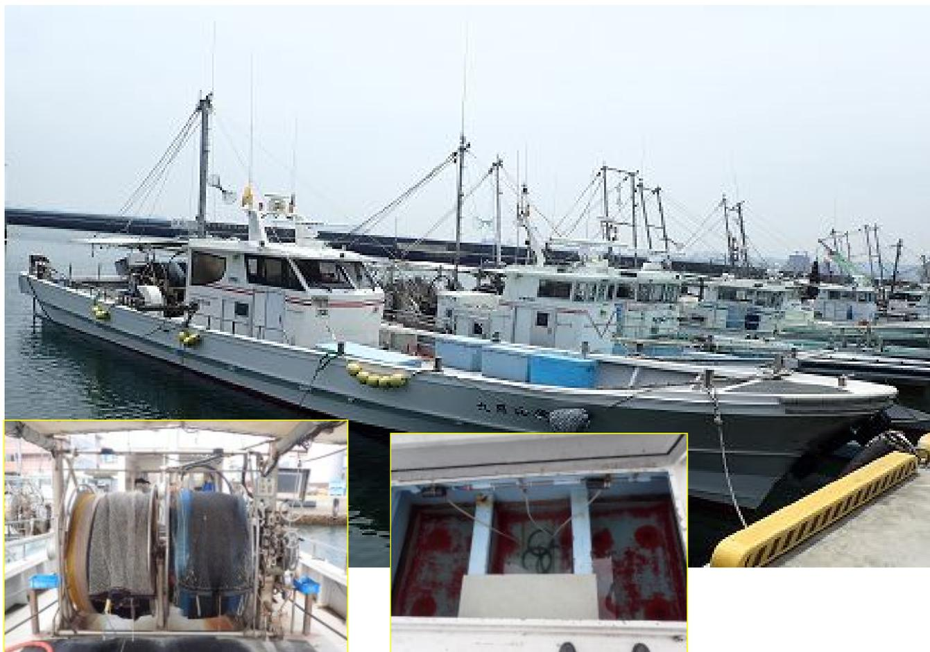
13トンクラス底びき船とネットローラーと船上生け簀
