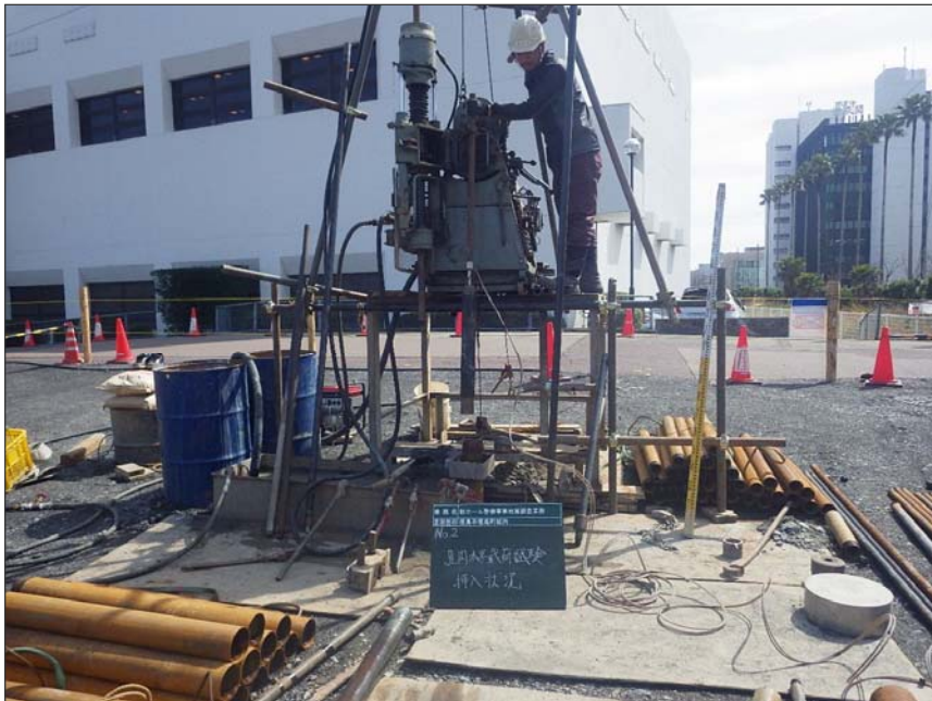
No. 2 孔内水平載荷試験
