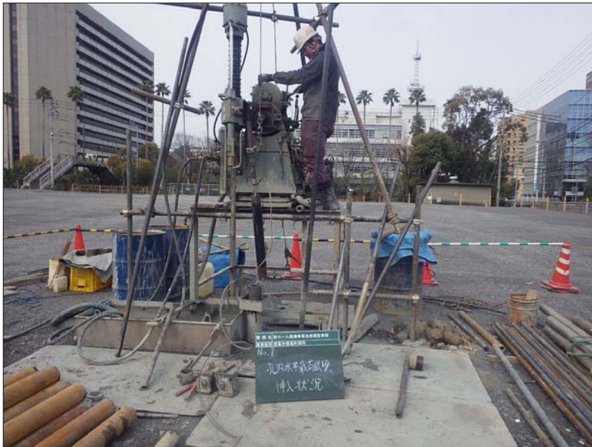
No. 1 孔内水平載荷試験
