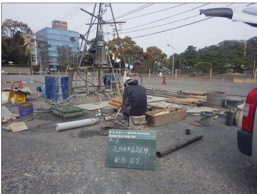
No. 1 孔内水平載荷試験
