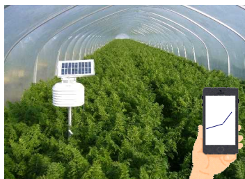
「ニンジン栽培施設内の環境を測定・配信するフィールドサーバー」
