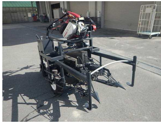
日本初の「タデ藍専用収穫機」
