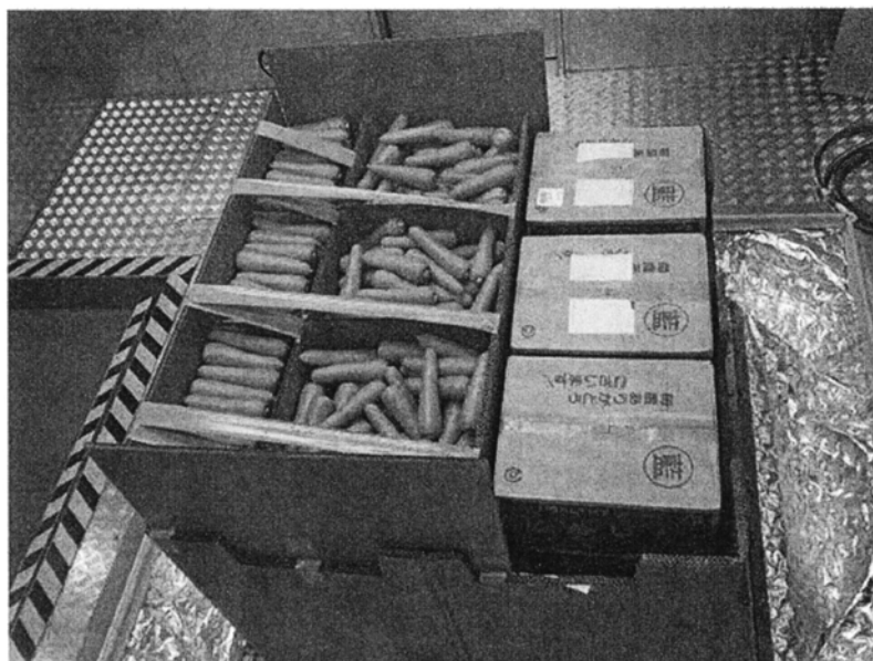
図6 ニンジンの振動損傷評価試験における出荷容器、充填方法、積載方法 写真左側から右側へ BC 整列区、BC 非整列区、段ボール区
