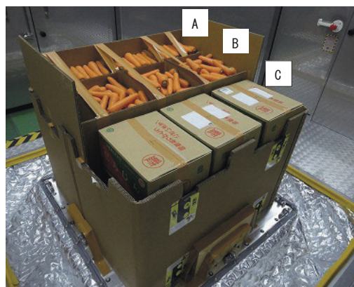
第4図 ニンジンへの振動損傷評価試験における出荷容器、充填方法、積載方法
