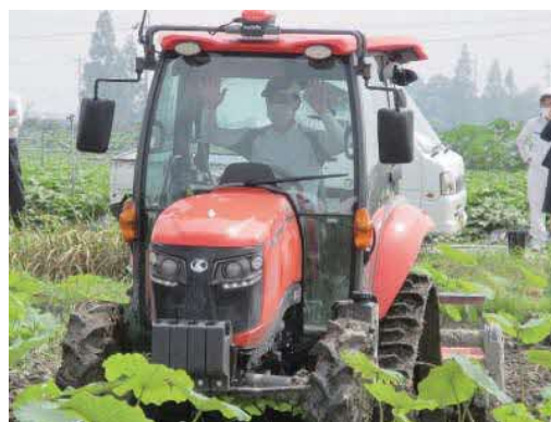
図2. 直進アシスト機能付きトラクタ
