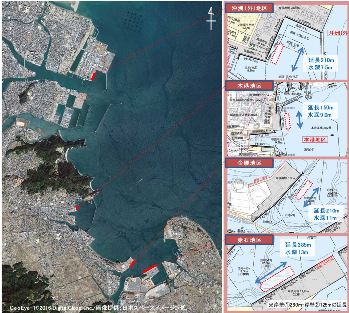
図 3.13 クルーズ船の寄港岸壁と岸壁諸元
