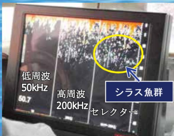
魚探のモニターに映し出されたシラス魚群。水深10～20m付近にシラスの反応が多く映っています。
