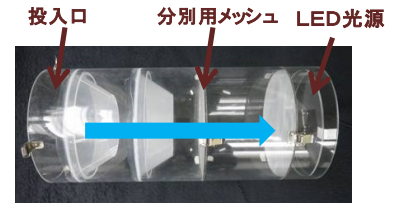
図3 土着天敵と微小害虫の分別装置
