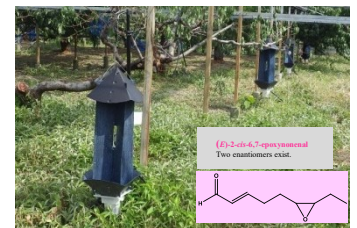
図4 モモ園内に設置した十字型衝突板トラップと合成したフェロモン名と構造
