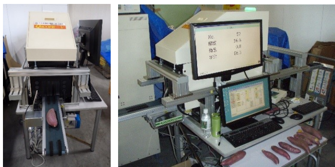
「なると金時」糖度センサーを搭載した非破壊糖度測定機
