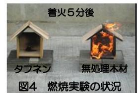
図4 燃焼実験の状況
