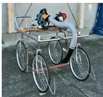
開発したタデ藍簡易収穫機 (株)栄工製作所製造)
