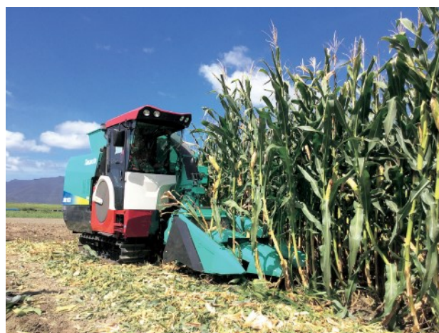
写真1 イアコーン専用「スナッパヘッド（本プロジェクト研究で開発）」を装着した収穫機
