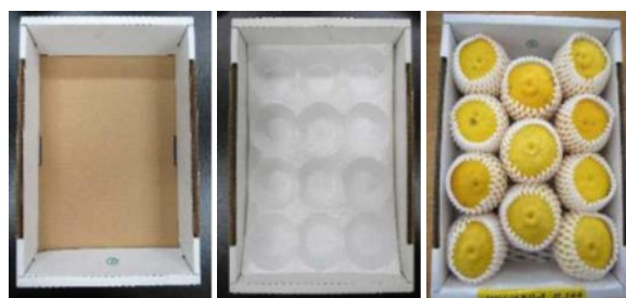
緩衝資材なし(無処理) フルーツトレイ フルーツキャップ+ネットシート 写真2 設定した試験区（2017年12月）
