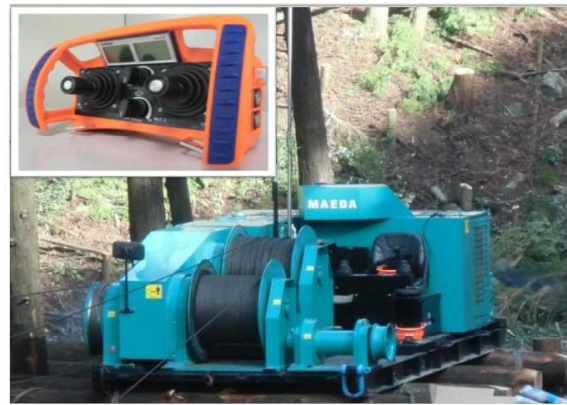
ラジコンで操作できる油圧式集材機
