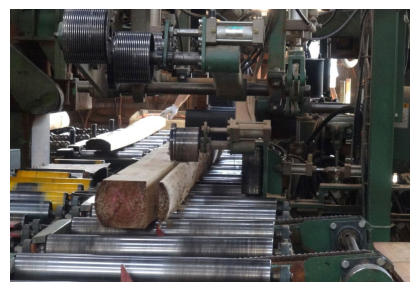
開発した新型帯鋸の実証試験
