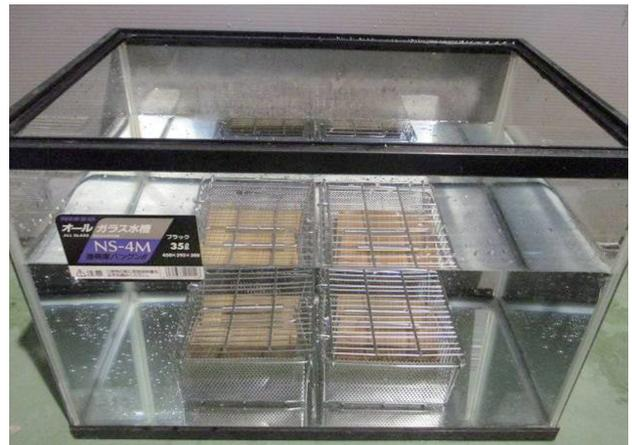
第6図 スギ柾目集成材における薬剤溶脱率試験の状況
