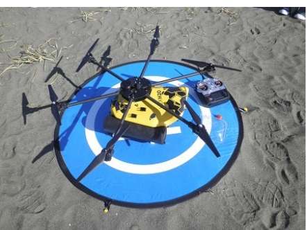
▲マリンドローンを有し、普段は藻場マッピング調査等に活用し、発災時には沿岸部の被害調査に役立てる予定です。阿南高専と連携して技術を磨いています。
