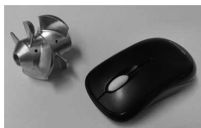
徳島大学が研究中の インライン式小型 hidro タービン (左)
