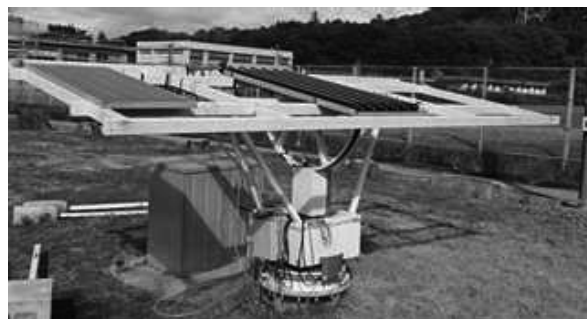
徳島大学が設置した二軸太陽追尾装置
