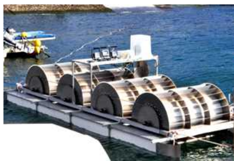
阿南工業高等専門学校が 阿南市伊島に設置した 潮流発電（上）・波力発電装置（右）
