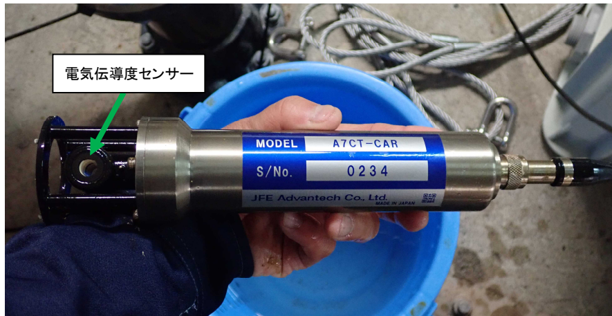
写真 2. 有線式水温塩分センサー
