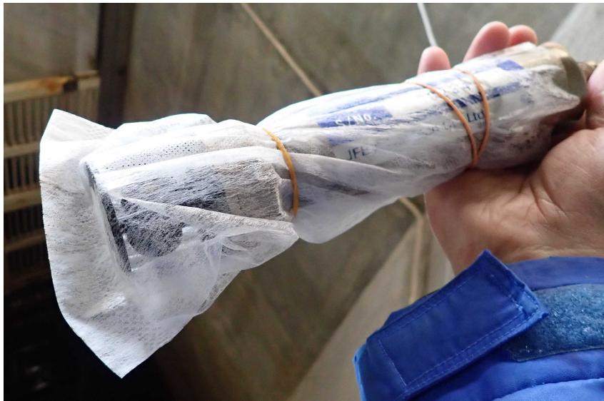
写真4. ネットで覆った水温塩分センサー
