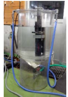
リアルタイム硝酸塩センサー
