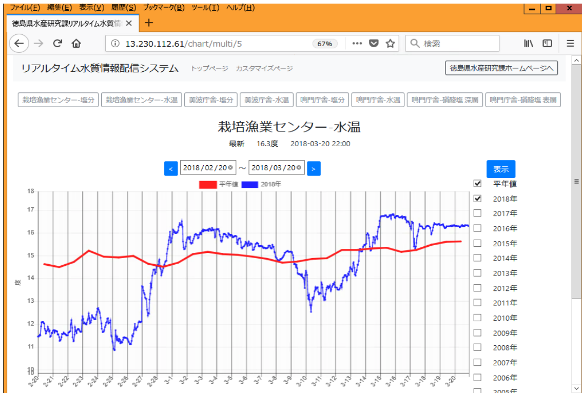
図3. グラフ表示画面の一例（栽培漁業センターの水温）。赤線は平年値。カレンダーを表示させて表示期間を変更することができるほか、右側に並べた“年”をチェックすることにより複数年を重ね合わせて表示できる。
