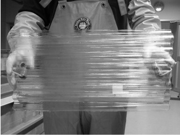
写真1．透明波板3枚を重ね合わせて作製した附着器
