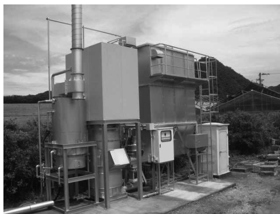
バイオマス小型熱交換炉
