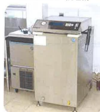
真空包装容器に充填した食品を高温加圧下で殺菌・調理する機器。常温で長期保存が可能なレトルト食品の試作ができる。
