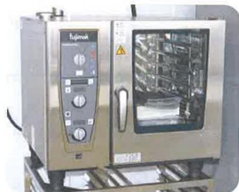
水蒸気と熱風の量を設定し、「焼く・煮る・蒸す・炊く」などができる多機能加熱調理機。惣菜、菓子の試作ができる。
