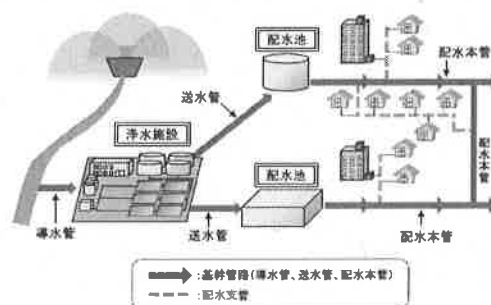
水道施設の概略図（河川取水）
