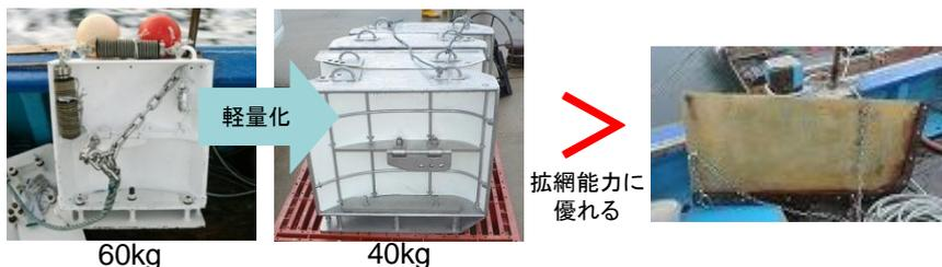
図1 高揚力オッターボード(株)ニチモウ製 写真左, 中)と従来使われてきた平板型オッターボード(写真右)
