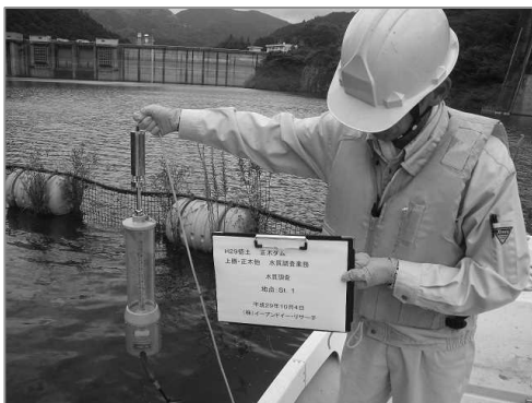
施策2-1 採水器を用いた水質調査
