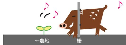
正常に電気が通ってこそ効果が発揮されます。イノシシの毛は電気を通しません。そこで、電線を鼻に当てるため、電線を張る間隔を高さ 20cm にします。
