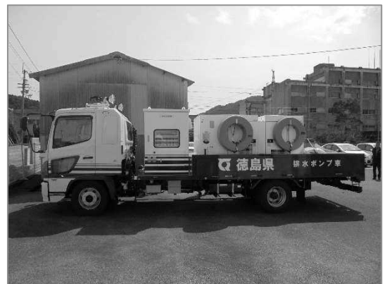
施策 1-8 機動的かつ迅速な排水活動が可能な排水ポンプ車の配備
