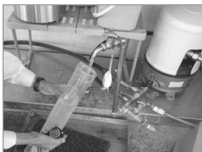
施策 3-1 ポンプの揚水量調査状況
