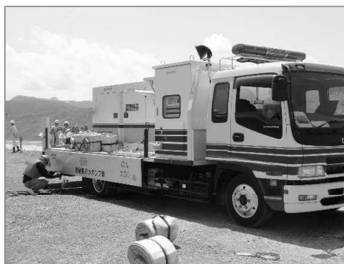
施策1-3 機動性に優れた排水ポンプ車による排水
