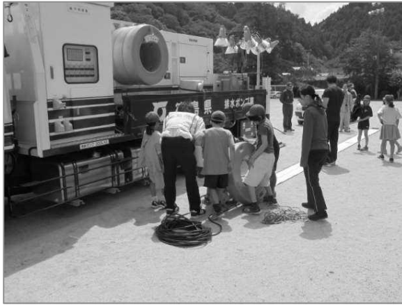
写真2-48 排水ポンプ車にホースを接続
