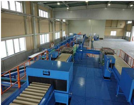
大根の洗浄から等級選別までの工程を自動で行う共同選別施設（JA大津松茂）
