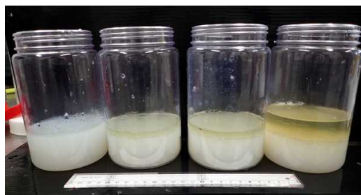
写真1. 改良型施肥剤（1 L 瓶タイプ） 左から，蓋なし，蓋-7mm，蓋-10mm，蓋-20mm。
