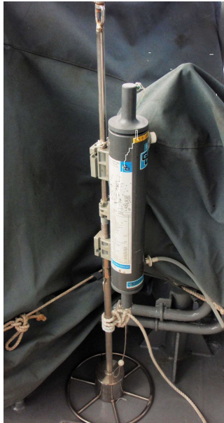
写真1. 漁業調査船とくしま船舶職員が開発した底層採水装置
