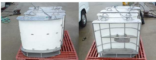
図1. FRP製高揚力オッターボード(ニチモウ(株)製、1枚あたりの重量40kg、大きさ600mm×600mm、厚さ300mm)。ステンレスの骨組みにFRPの外板を取り付けた張殻構造で、高揚力を得るための形状がデザインされている。
