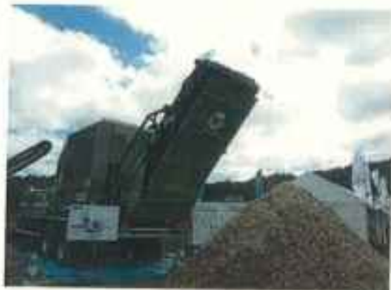
現場でバイオマス燃料を生産する 移動式木材チップパー
