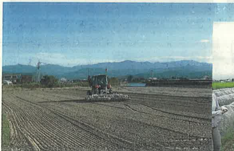
「ほうれんそう」の湿害対策に向けたレーザーレベラーによる緩傾斜処理
