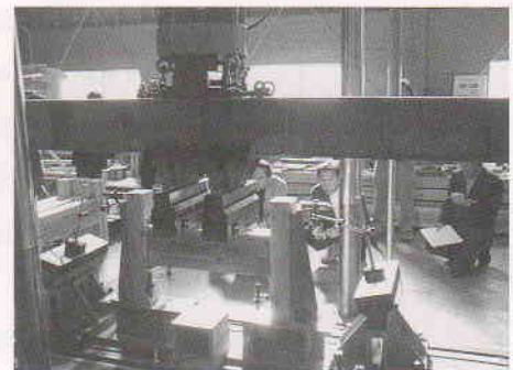
写真2 接合部の強度試験
